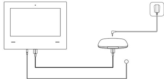
3. Befestigen Sie das IR-Verlängerungskabel an der Mues-Tec TV-Einheit und stellen Sie sicher, daß der IR-Sensor des Kabels eine direkte Verbindung zum IR-Empfänger der Smart-Box aufnehmen kann.
