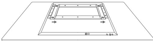
1. Befestigen Sie die Montagehalterung an der Rückseite des Smart-Spiegels..
