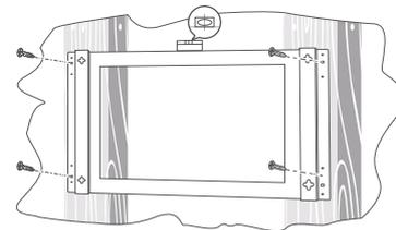
2. Montieren Sie nun die Befestigungswinkel an der Wand.
